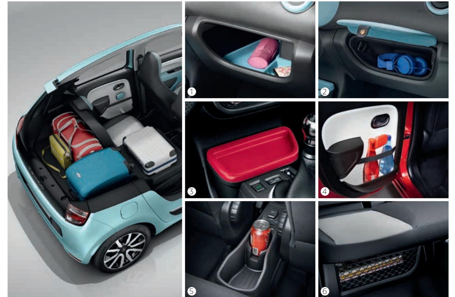
1 Offenes Handschuhfach mit farbigem Ablagefach. 2 Abnehmbares Handschuhfach (Tragetasche). 3 Herausnehmbare Box unter der Mittelkonsole. 4 Ablagefach in den hinteren Türen. 5 Ablagekonsole zwischen den Vordersitzen. 6 Ablagefach unter der Rücksitzbank.
